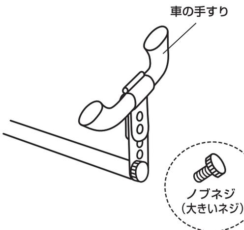
ステー金具 (ジョイント金具) を継ぎ足してバーの高さを調節して下さい。
